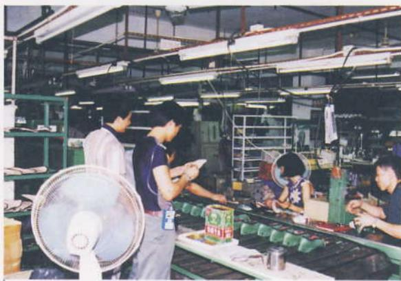
圖55. 使用個人取樣器，測量員工在工作時暴露於有害物質的濃度。
