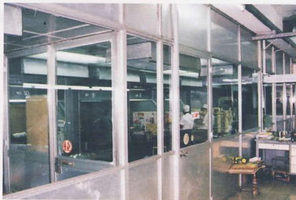
圖 39. 把噴油工序與其他工序隔離，使外面工人不致受到影響。
