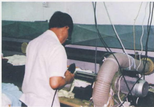
圖35. 製衣業使用鎗水清潔污漬時，採用局部抽氣設備直接把有害物質從污染源抽走。
