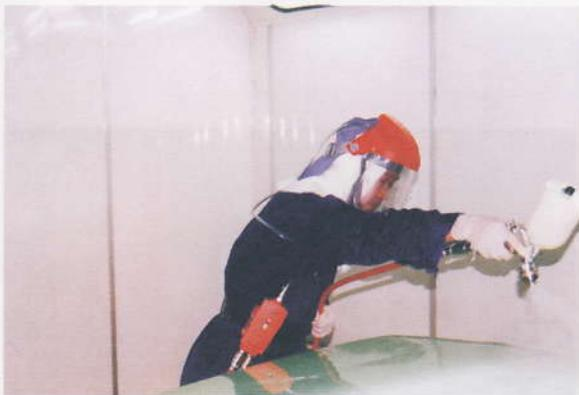
圖49. 噴油時使用的風喉式呼吸器。
