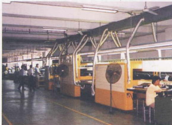
圖34. 鞋廠內沿生產線安裝的抽氣系統。
