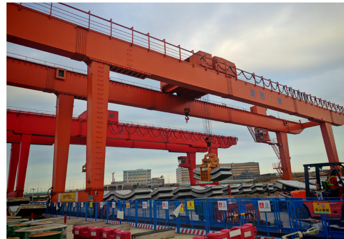
▲ 東線項目現有 2 台龍門吊機，是隧道工程的重要機械，負責橫向及垂直運輸隧道結構的主要組件管片及弧形件，從堆放場地運送至井下進行後續安裝工作。
