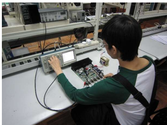
Depuração da placa de circuito de som pelos principiantes do Curso
