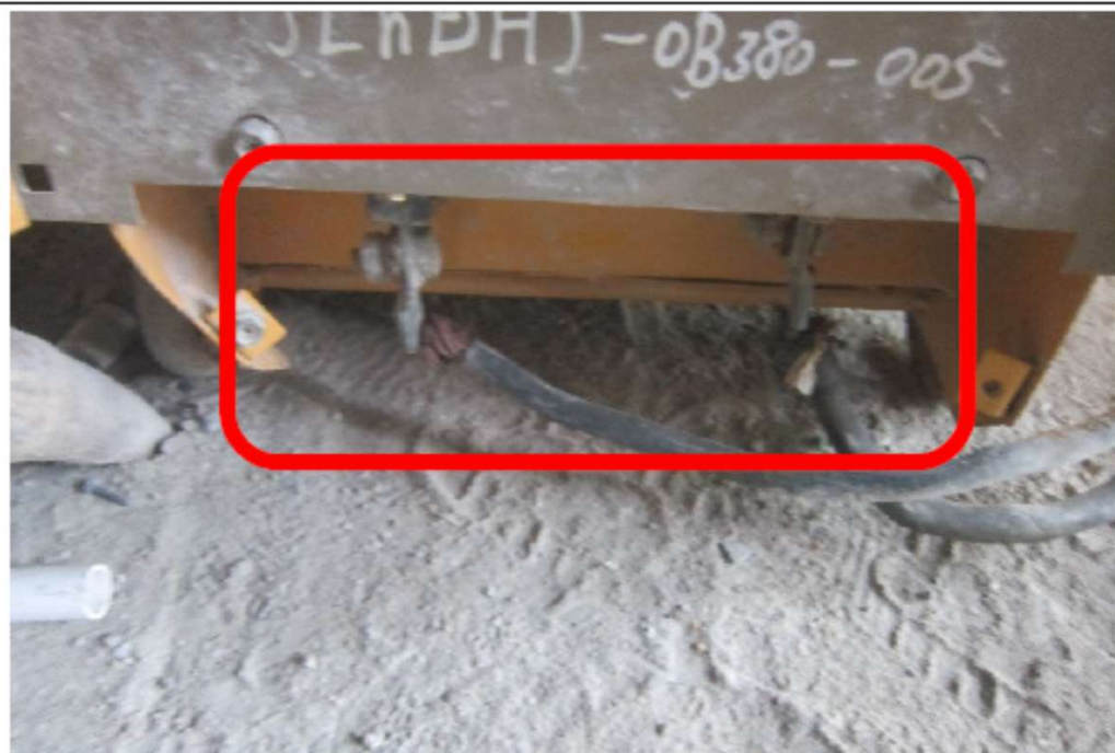
焊機的帶電部分外露
