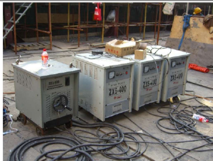
焊機的帶電部分已被遮蓋
